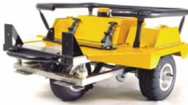
Simplemente siendo remolcado por cualquier vehículo, funciona de la misma forma que el SCRIM y puede comprobar 80kms por cada tanque de agua.
